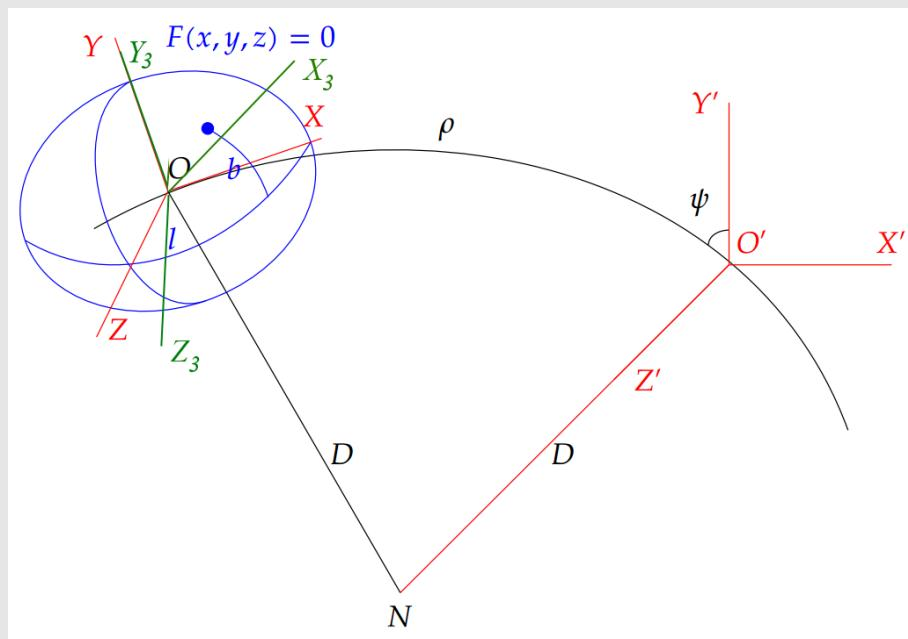
**4. Поворот на угол  $l_0$  вокруг оси  $Y_3$ , чтобы ось  $Z$  оказалось направленной на точку с нулевыми планетограф. координатами:**
