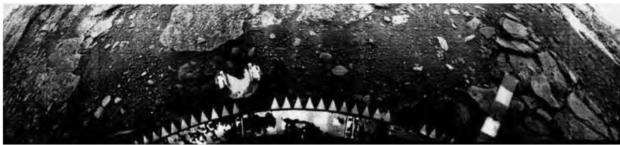
Рис. 2.5.4. Одна из панорам (красный фильтр), переданная АМС «Венера-13». Эта панorama использовалась для калибровки и количественного анализа. Камера находилась на высоте около 1 м над поверхностью; в центральной части панорамы камера «смотрела» вперед и вниз, захватывая в поле зрения нижнюю часть спускаемого аппарата; на краях панорамы камера «смотрела» выше, захватывая небольшие уголки неба
