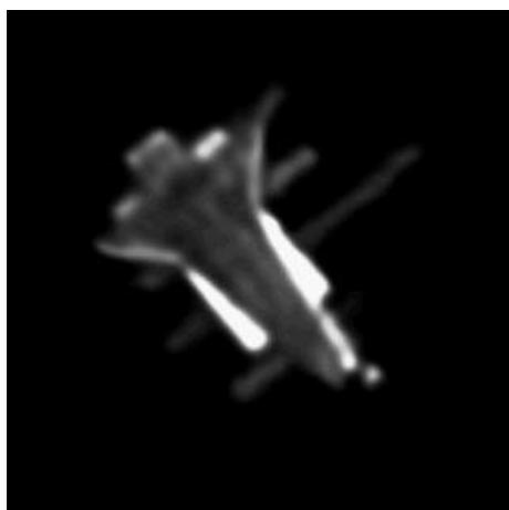
Рис. 2.11.1. Изображение орбитального космического комплекса «Мир-Атлантис» по результатам наблюдений на 1.1-метровом телескопе (гора Майданак). Светоприемник – ЭОП, регистрация на фотопленку. Сканирование и оцифровка изображений выполнена на быстром микрофотометре (Вакулик и др., 1994), обработка с помощью цифровых методов
